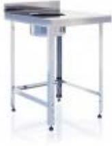
Стол ССОП Э выполнен из нержавеющей стали, толщина столешницы - 0,8 мм, разборная конструкция, решетчатая полка, каркас - оцин уголок 40\*40\*1,5 мм, Нстолешницы - 40 мм, Нборта - 40 мм, столешница усилена ЛДСП толщиной 16 мм, отверстие 225 мм, расположение отверстия по центру, резиновое кольцо в комплект не входит, регулируемые ножки(+/-20мм), отступ от края 60 мм
