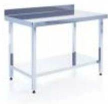
Стол разделочный СРПН Ш выполнен из шлифованной нержавеющей стали, толщина столешницы - 1 мм, разборная конструкция, каркас - труба 40\*40\*1,2 мм, Высота столешницы - 60 мм(радиусный гиб - 7 мм), Высота борта - 85 мм, столешница усилена ЛДСП толщиной 16 мм, регулируемые ножки(+/-10мм), отступ от края 60 мм
