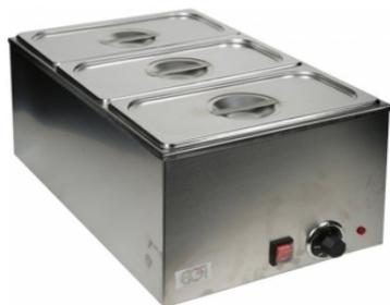
Мармит электрический настольный, с 1 ванной, нагревом «парового» типа, регулируемым термостатом, изготовлен из нержавеющей стали. Объем - 36л. Вместимость ванны - 3GN1/3-150мм (в комплекте с крышками). Температурный режим от +30С до +95С.
