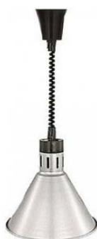
Лампа-мармит электрическая инфракрасная подвесная с абажуром серебристого цвета, регулируемым чёрным проводом предназначена для поддержания продукта в нагретом состоянии. Регулируемая высота - от 600мм до 1800мм. Диаметр абажура – 270мм.
